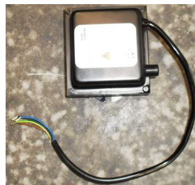
Figure 8: trasformatore di accensione TZI per alimentare gli elettrodi accenditori
